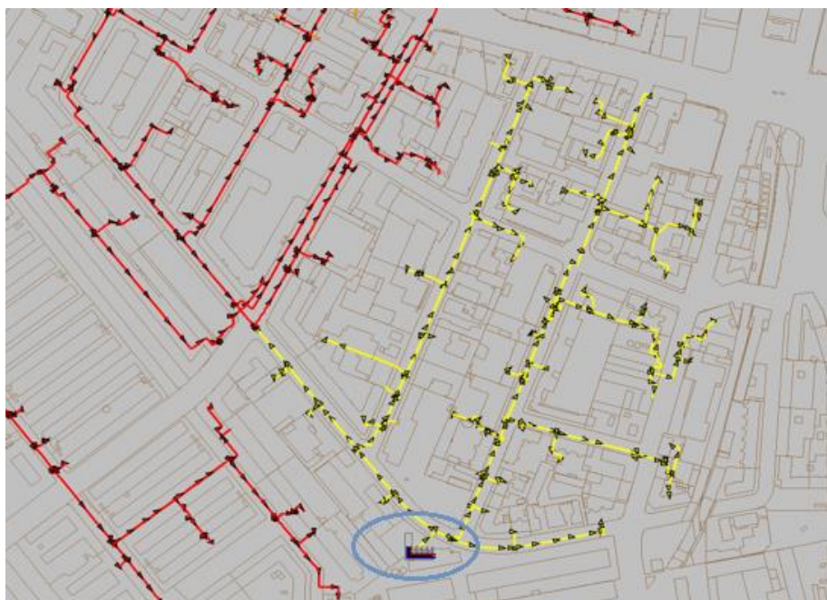
Figur 14: Decentral forsyning i fjernvarmenettet med Novozymes varmepumpen.
